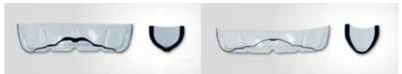
Einfluss der verschiedenen Preform-Kuppen auf die Flaschenböden.
